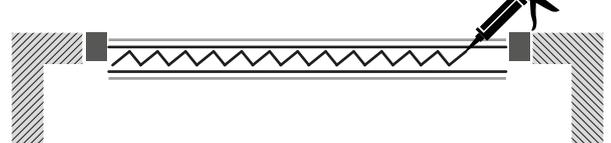
⑩ Finalmente, comenzando por un extremo, poner la junta sobre el adhesivo del suelo y presionar firmemente hacia abajo.
